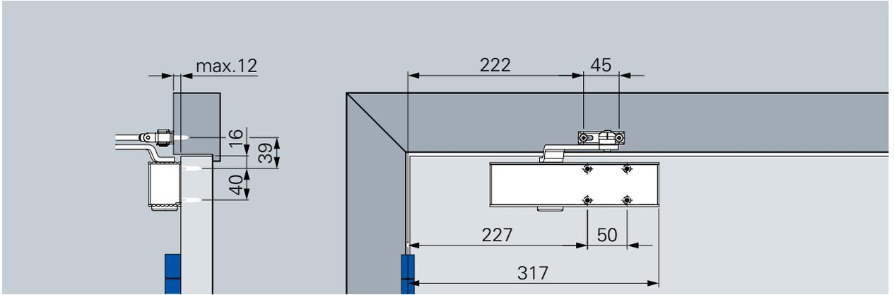
标准安装, 铰链侧 (EN 3),带安装版
