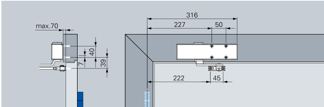
顶部安装, 铰链背侧 (EN 3), 带安装版
