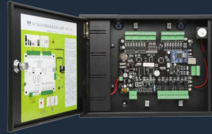
AC 22 双门双向控制器（可接入4个读卡器）
