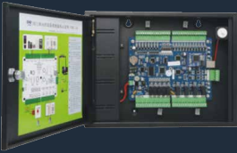
AC 41 四门单向控制器（可接入4个读卡器）
