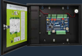
AC 12 单门双向控制器（可接入2个读卡器）
