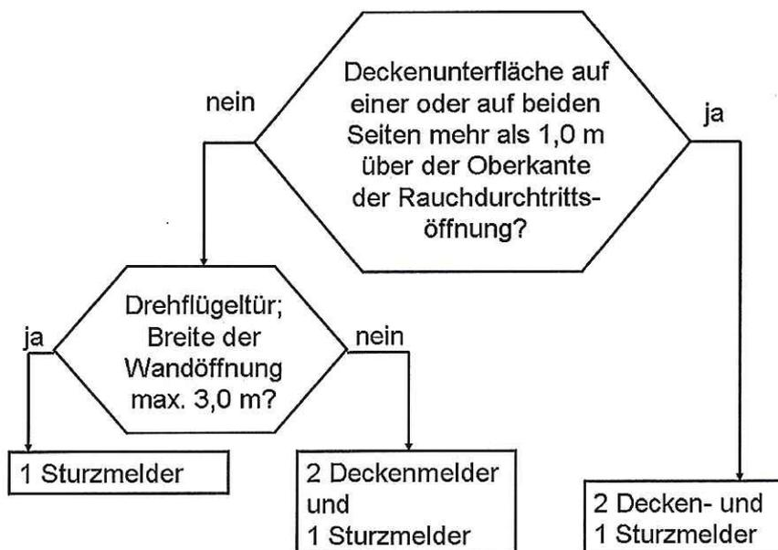
Bild 3: Entscheidungsdiagramm
